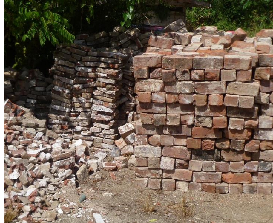
links : nederlandse bakstenen rechts : engelse bakstenen
