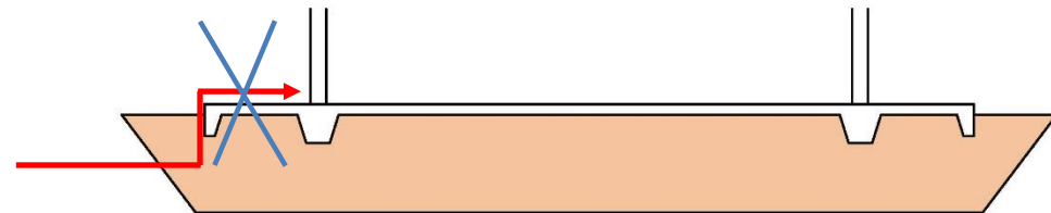
een buiten het gebouw uitstekende funderingsplaat. Houtluizen leggen NOOIT tunneltjes aan bovenop een begane grond vloer.
